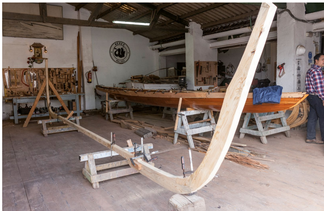
Astilleros Nereo en Málaga. Puesta en quilla (Eva Cote Montes, Fondo Gráfico IAPH )
